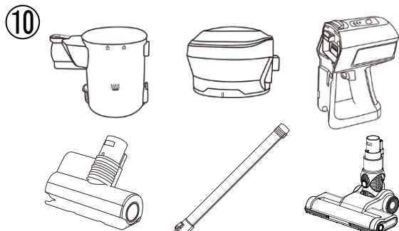
ダストカップ、モーター部、バッテリーハンドル部、延長パイプ、フロアヘッドカバー、布団ブラシは電装部品です。お手入れする場合は固く絞った雑巾などで拭いてください。よく乾いたことを確認してから組み立ててください。濡れたままご使用になりますと故障・感電の原因になります。
