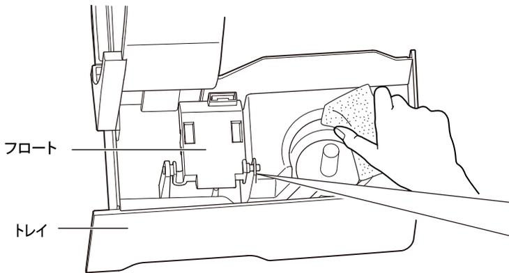
お手入れ中にフロートがはずれたときは以下の手順で取付ける。フロートがはずれた状態では正常に運転しません。
