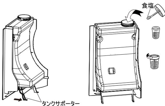
※床面にタンクを立たせる場合、タンクサポーターをしっかりと引き出して立たせてください。タンクサポーターを引き出さずに立たせた場合、不安定になり転倒し水漏れやタンクが破損する場合がありますのでご注意ください。
