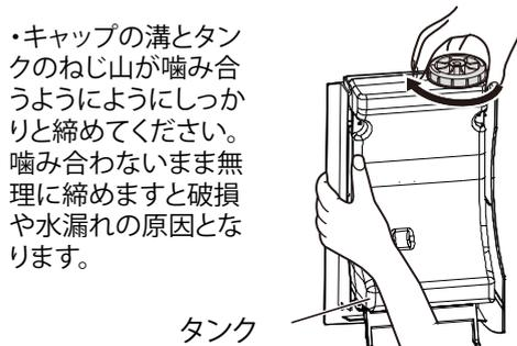
• キャップの溝とタンクのねじ山が噛み合うようにしっかりと締めてください。噛み合わないまま無理に締めますと破損や水漏れの原因となります。
